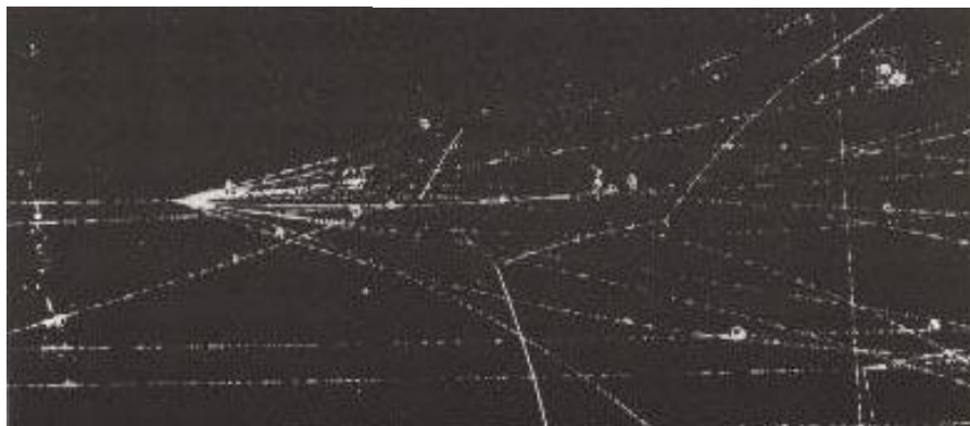
Creación de dieciséis partículas en una colisión entre un pión y un protón.
